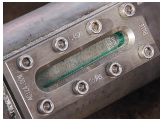
Monitorizarea continuă a fluxului de material de la Dense Phase Conveying în sus până la buncărul de umplere special conceput
